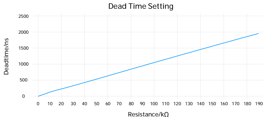
图 7 死区时间曲线图
